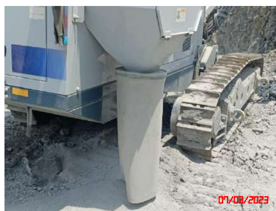
รูปที่ 7 เครื่องเจาะรูระเบิดที่มีอุปกรณ์เก็บฝุ่นติดไว้ที่หัวเจาะ
